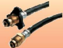
本产品是液化石油气用高压橡胶软管。有气相用和液相用两种。当LPG的容器更换时，由于液相管内藏止回阀，因此拧下手柄时，止回阀作动切断通路，防止胶管内的液体流出。
