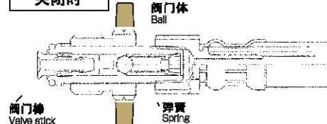
松开接缝，弹簧的自然伸长使得小球回到原位置。
